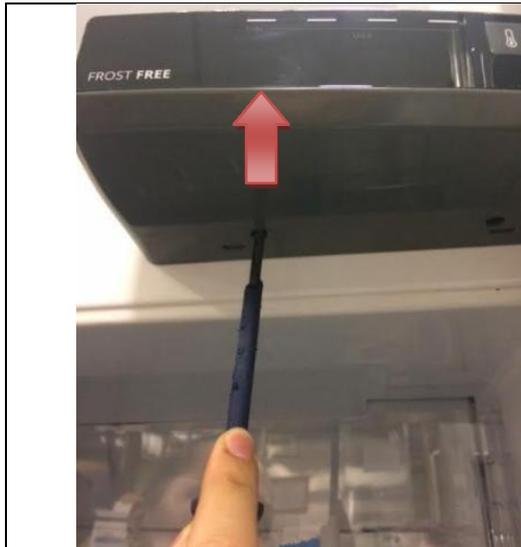
Con la ayuda del ojo de la cerradura empujar el pestillo de la cubierta izquierda hasta la completa eliminación.
