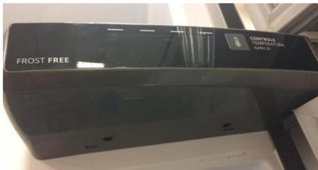
El caso de control electrónico este producto tiene un nuevo concepto en el que la eliminación, en primer lugar, debe ser empujado con una llave de extremo delgado, dos pestillos superior situado dentro de la campana.
