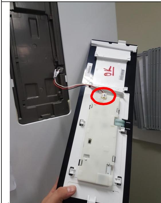
Retire la interfaz de conector de alimentación y obtener acceso al componente.
