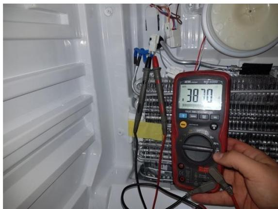
*Probar la resistencia óhmica de la resistencia de descongelación.*
