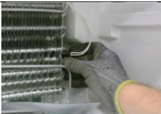
La extracción de la fusión en caliente de su nicho entre las aletas del evaporador intercambiarlo.
