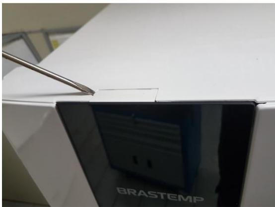
La tarjeta de interfaz de estos productos tiene un nuevo concepto en el que la eliminación, en primer lugar, se debe quitar con un destornillador de punta fina, un cierre superior en la puerta de la cabeza del producto.
