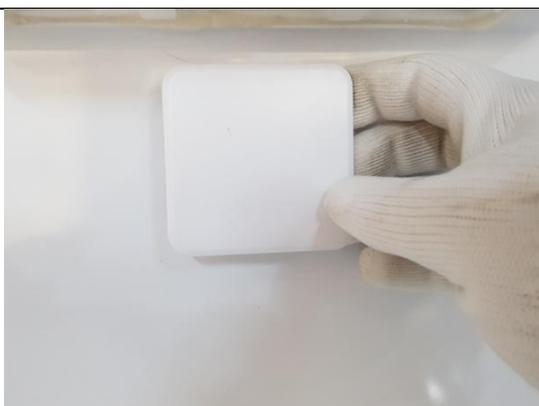
Tire de la cubierta del alojamiento del sensor más frío.
