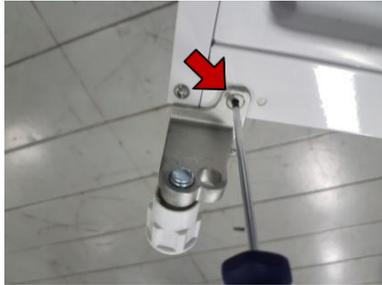
Para eliminar el nivelador pierna rueda frontal y con un Torx T20, quitar los tres tornillos de fijación cada una.
