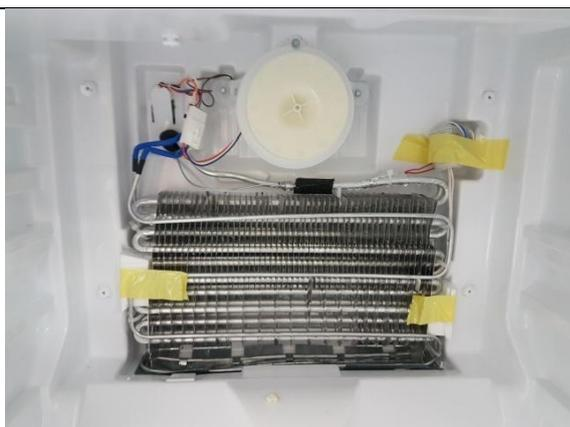
Obtener acceso al evaporador, descongelar resistencia deshielo carril, ventilador de montaje, y la fusión sensor fusible.
