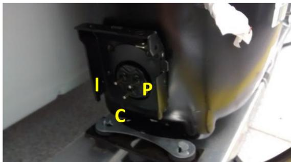
Para comprobar el devanado principal / movimiento con la ayuda de un multímetro para medir el valor óhmico entre el pasador principal (P) y común (C) y escribirlo.
