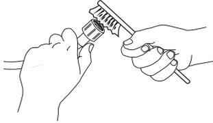
3. A continuación, desenrosque la manguera de entrada de la parte trasera de la lavadora. Extraiga el filtro de malla de la válvula de la parte trasera de la lavadora con unas pinzas y límpielo con cuidado.
